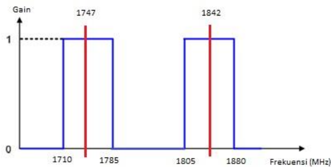
Gambar 3: Respon spesifikasi dualband BPF frekuensi 1800 MHz.
